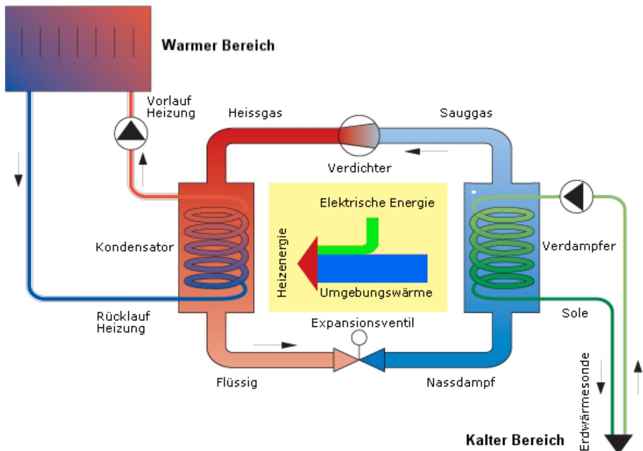
Abb.2: Funktionsweise Wärmepumpe (Quelle: [www.k-w-info.de](http://www.k-w-info.de), überarbeitet)
