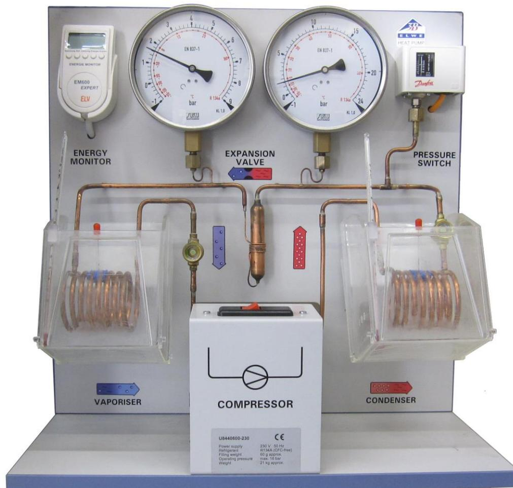
Abb. 1: Wärmepumpe (»pompe à chaleur«) (Foto: Kiesgen)
